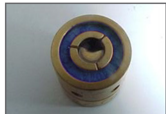
Stuknitningsverktyg ej OK. Dynans botten skadad.
