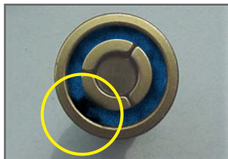
Stuknitningsverktyg ej OK. Dynans elastomer är brusten.
