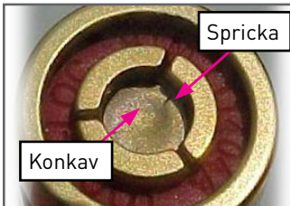
Stjärnliknande spricka och/ eller fördjupning i dynans botten.
